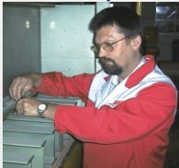
Montage der Heizplattenbefestigungen am Pressentisch.
