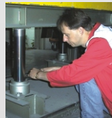
Einstellarbeiten am Hydraulikzylinder einer Furnierpresse .
